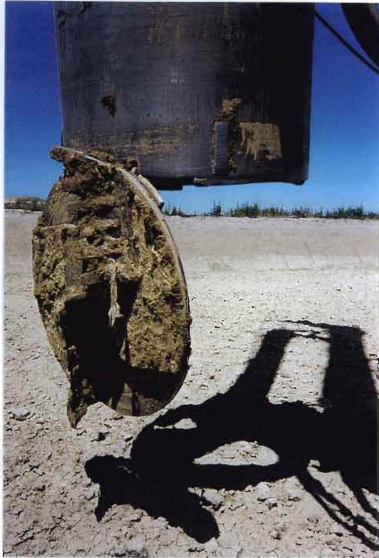
F.5 Detalle de la cuchara para la evaluación de detritus. "Bucket"
