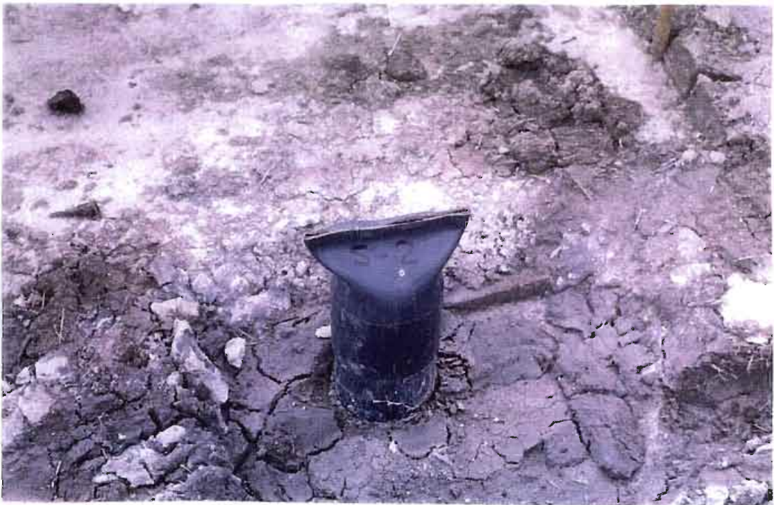
B.6 Entubado del sondeo de control S-2
